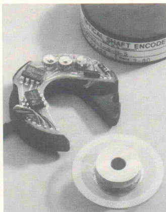
Bild 1. Modular aufgebauter Winkelschrittgeber. Von unten nach oben: Impulsscheibe, Abtasteinheit, Gehäuse-Kappe (Foto: Teldix).
